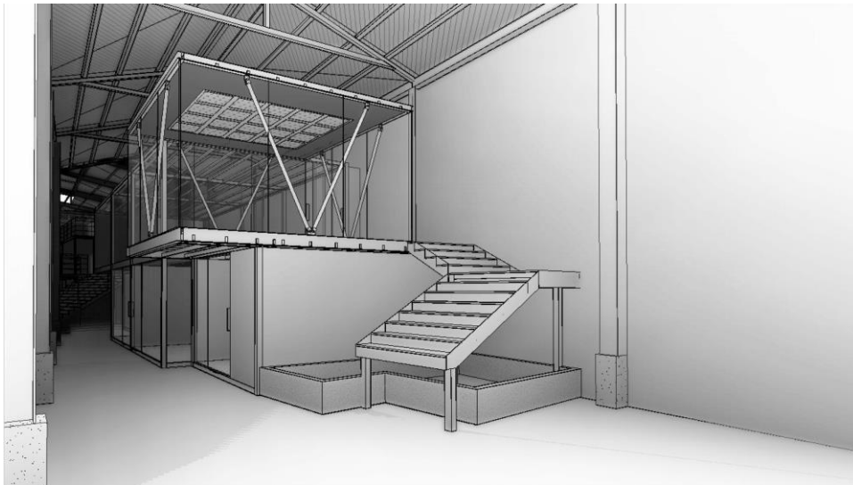
Hình 1.4 Minh họa mô hình BIM hiện trạng công trình được lập dựa theo đám mây điểm 5
